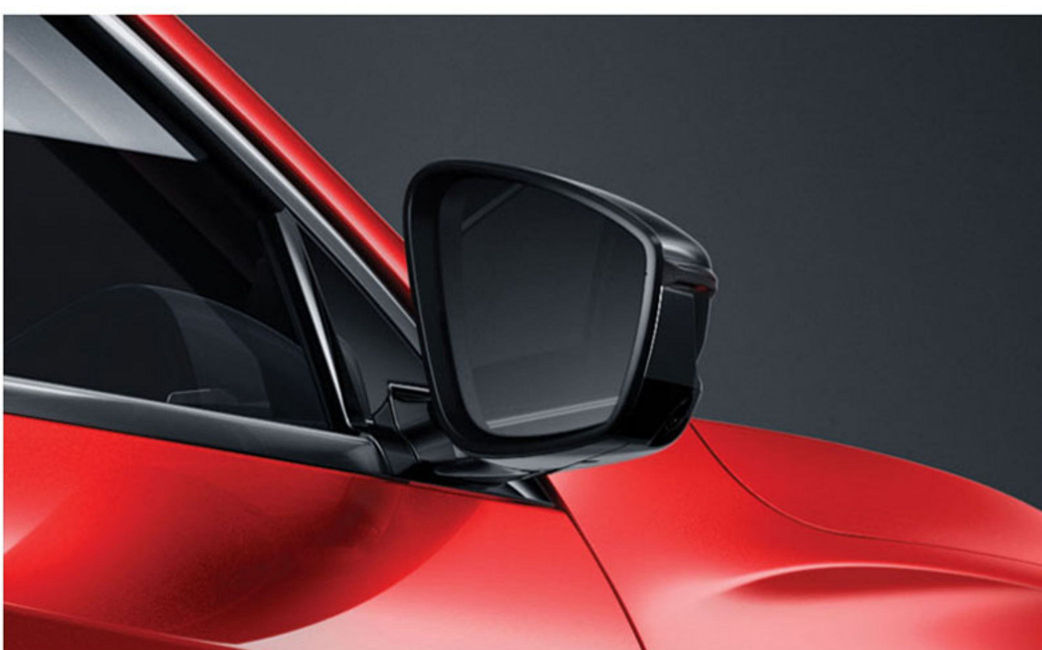
تغییر زاویه آینه های جانبی به صورت خودکار هنگام حرکت به عقب
